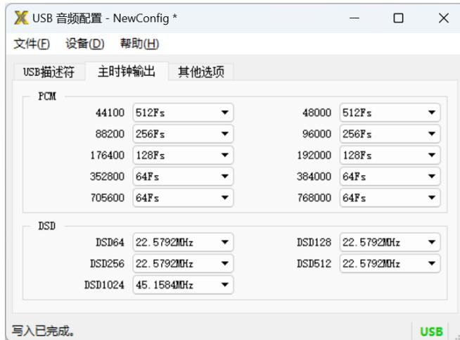
写入完成后，需要将音频界面与“工程配置模式工具”断开连接。请点击“设备”菜单，然后点击“断开”命令即可。此时，程序右下方的“USB”字符由绿色变成灰色。表示断开成功。
