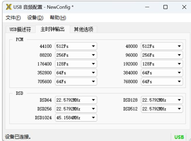
如果没有连接成功，请确认您的音频界面是否处于工程配置模式。若不是，请参考章节“进入工程配置模式”，首先让音频界面进入工程配置模式。再次点击“设备”菜单，然后点击“写入”命令，即可将数据写入音频界面。写入过程非常快，此时可以看到程序左下方的状态栏会提示“写入已完成”。
